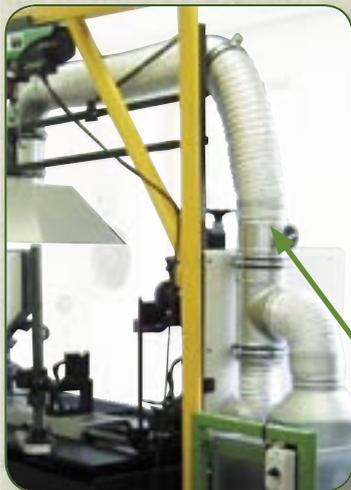
Am Schleifturm befindet sich ein Absaugschuh für den Rund- und Hinterschliff sowie ein Absaugschuh für den Untermesserschleif. Diese nehmen den Schleifstaub direkt an der Entstehungsstelle auf.
