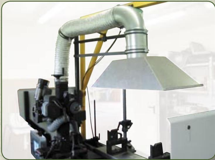
Die Absaugung ist an die Größe und Position des Mähwerkes zur Optimierung der Absaugleistung anpassbar.
