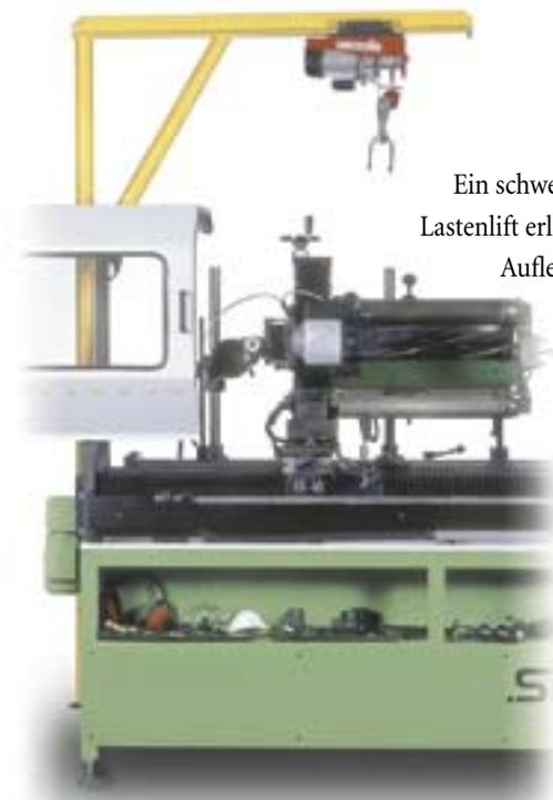
Ein schwenkbarer Lastenlift erleichtert das Auflegen
